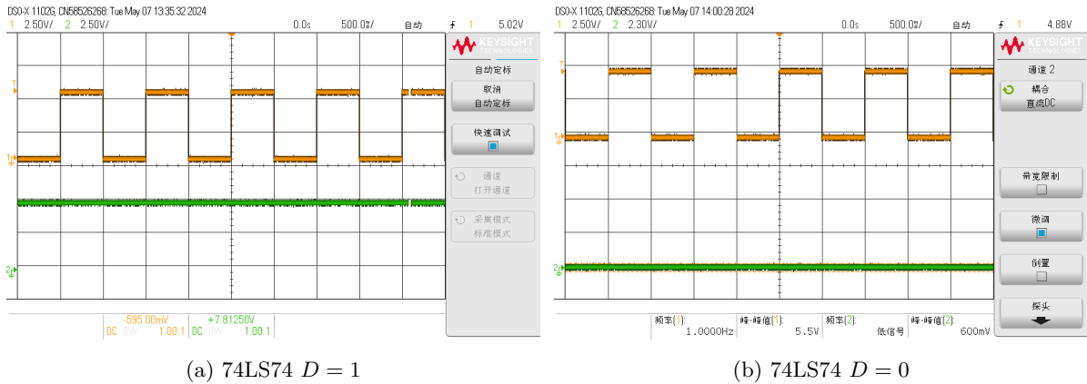
图 5: 74LS74 D 触发器功能测试
